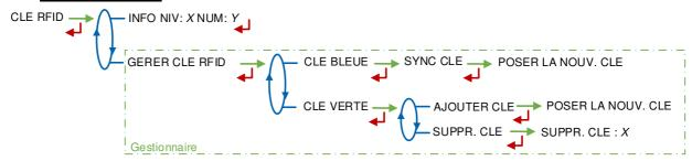
INFO: Affichage du niveau et de l'identifiant de la clé RFID présente sur l'afficheur (clé bleue : Niveau1-Superviseur, clé verte : Niveau2-Gestionnaire, clé rouge : Niveau3-Maintenance)
