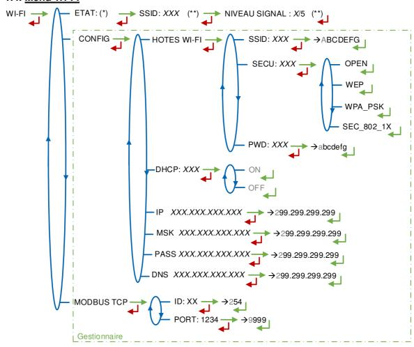
(\*) NON DISPONIBLE (le calculateur n'est pas équipé) / DECONNECTE / CONNECTE (\*\*) SI CONNECTE
